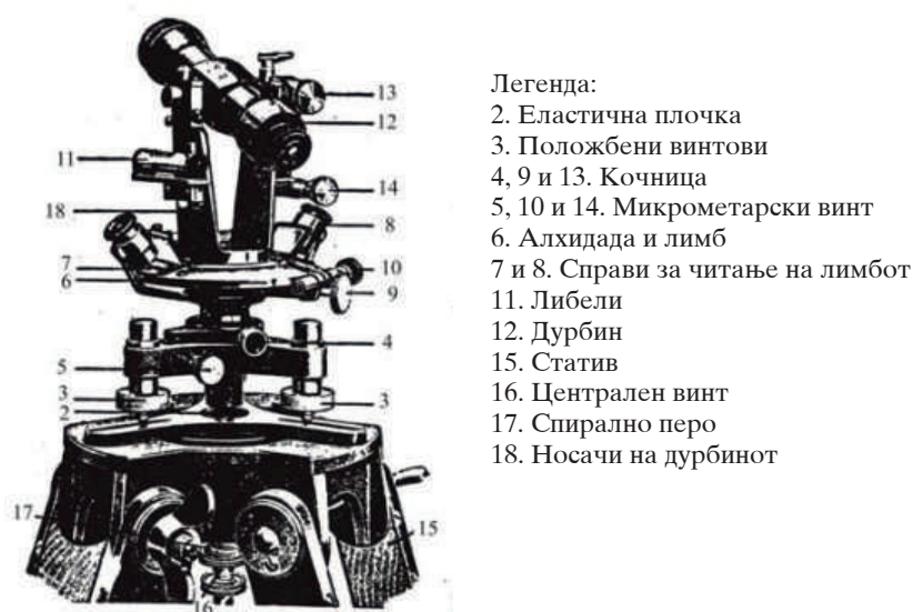
Сл. 7.3. Геодетски инструмент – теодолит.
