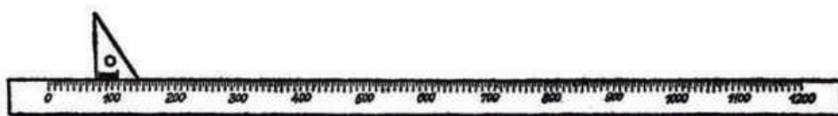
Сл. 13.14. Прибор за конструкција на рамката на листот (линијар и мал правоаголен триаголник).
